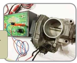
Si usted va a reparar un cuerpo, puede probar el motor de manera libre; o sea, sin engranes: coloque el botón en Auto y alimente el equipo; el motor se activará y desactivará automáticamente. En cuerpos semiautomáticos (los que tienen chicote), la apertura de la mariposa será ligera.
