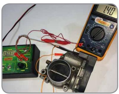
Una medición importante, es la de corriente de consumo del motor del cuerpo de aceleración. Para ello, coloque el multímetro en función de amperímetro en serie entre el equipo y el motor. La corriente no debe exceder los 2.2 amperios; si es así, debe reparar el cuerpo.
