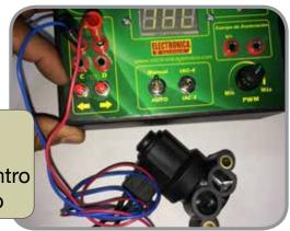
Ambos tipos de válvulas IAC, se pueden activar presionando los botones de las flechas. Puede colocar el botón en IAC-2 o en IAC-4, según le convenga, pues en ambas posiciones se activa. Después de probar las IAC desconéctelas del equipo, ya que pueden activarse y sobrecalentar al equipo o a la IAC.
