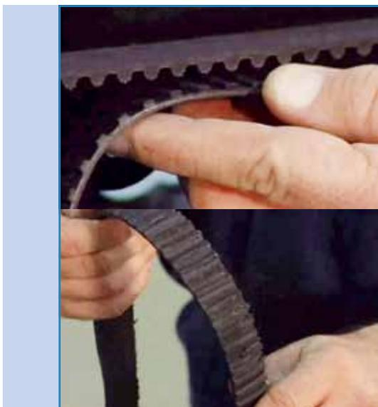
Y un caso que se comenta, y que realmente puede ser delicado, es cuando se cambia la bomba de agua y ésta no tiene la misma configuración de los dientes (redondeados o cuadrados), porque no corresponde al año correcto del vehículo. Y de ahí la importancia de disponer de un buen catálogo para buscar las piezas que se necesitan.
