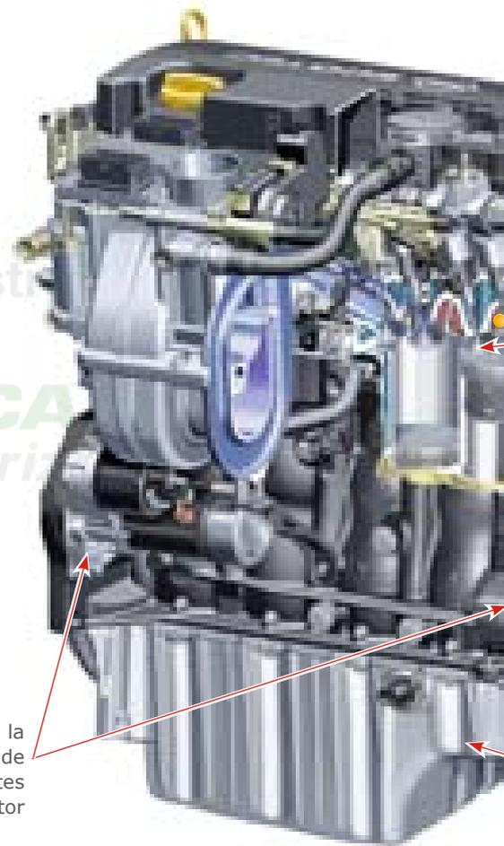
Bases para la instalación de los soportes del motor
