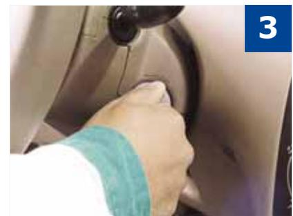
3 Inserta la llave de encendido y gira el switch de ignición hasta la posición de ON, para cerrar el circuito de alimentación eléctrica del módulo del sistema ABS. De esta manera, se inicia la función de autodiagnóstico.
