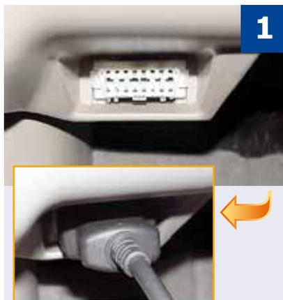
1 El escáner debe estar conectado en el conector de comunicaciones de datos (DCL), cuya ubicación varía de un vehículo a otro. Para localizar este conector en el automóvil, consulta el manual de servicio. Una vez ubicado el DCL, se conecta el cable de interfaz del escáner en el puerto correspondiente.
