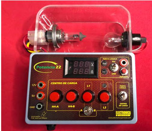
El POTENCIA-22 nos permite probar la batería de un auto al vacío y con carga. Con este equipo podrá medir el voltaje de la batería sin aplicar carga, luego se podrá solicitar una corriente controlada por medio de sus interruptores, y al mismo tiempo medir la corriente circulando y el voltaje de batería, para determinar si no hubo una caída.
