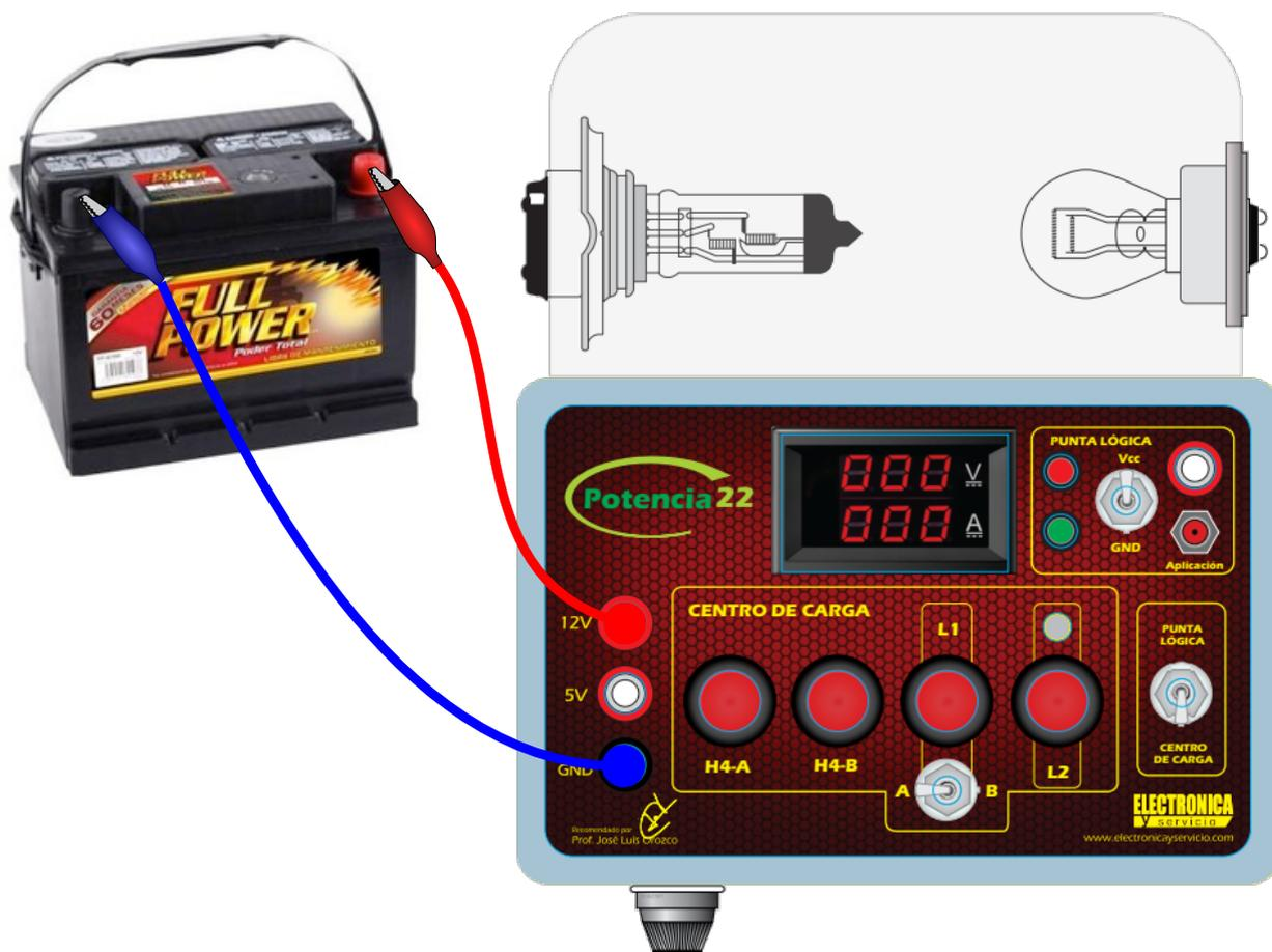
Conecte el POTENCIA-22 a una batería en buen estado y cargada, cuidando la polaridad correcta de los cables.
