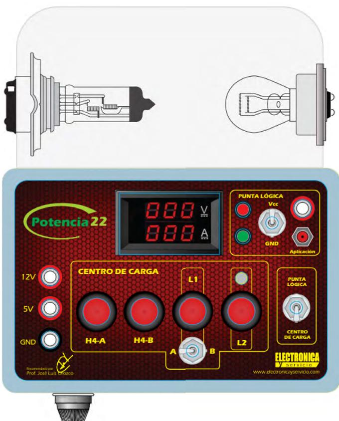
Gracias por adquirir el equipo de prueba y diagnóstico automotriz POTENCIA-22, el cual está diseñado para facilitar la detección de problemas en el cableado de un vehículo, haciendo una prueba dinámica de medición de voltaje bajo condiciones de carga controlada.
