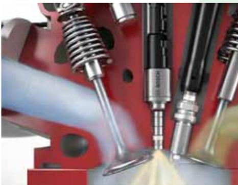
En la cámara de combustión de un motor con inyección directa de gasolina ingresa la mezcla aire-combustible, la cual es encendida por la bujía.
