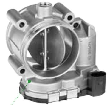
En un sistema de inyección electrónica el cuerpo de aceleración regula la entrada de aire al motor. Para su función incluye un sensor de ángulo que mide la apertura de la válvula (mariposa).
