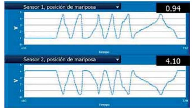
*Visualización con osciloscopio de la señal real entregada por los sensores*
